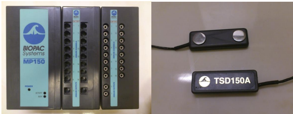
圖 3-2 Bipac MP150 肌電訊號收集系統
