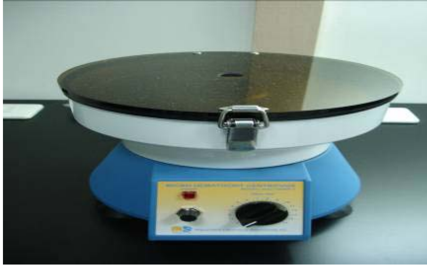
圖 3 - 1 血 乳 酸 檢 測 儀 器 血 液 分 離 機
