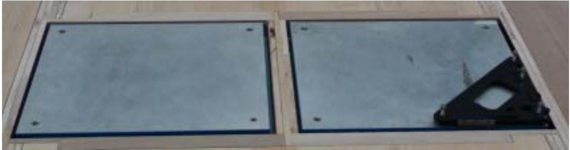
圖 3.7：L 型靜態校正器 (L-frame)，至於右側力板上，將實驗室座標系原點定義於力板右下角
