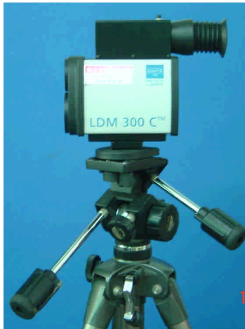
圖 1：高頻雷射距離測量系統。（LDM module 300C）
