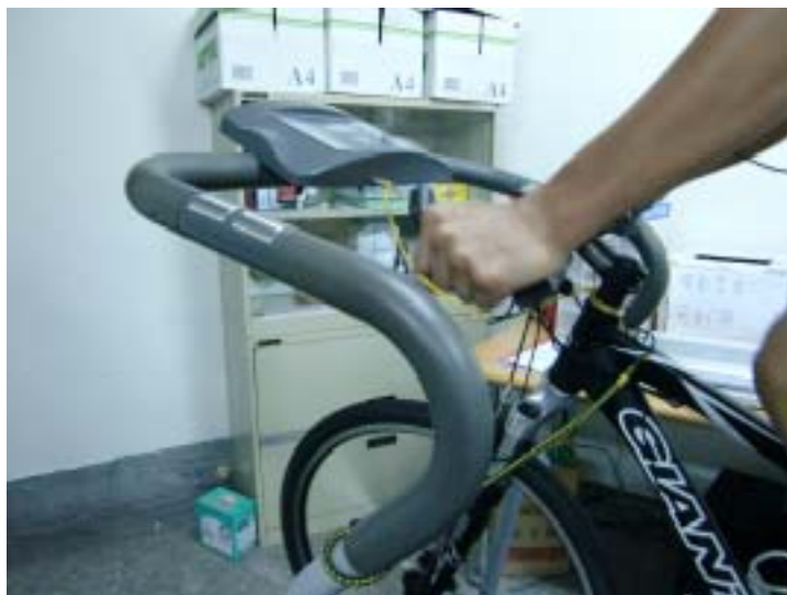
圖 3-6 警示線。在騎乘過程中，騎乘者應隨時保持此警示線呈現鬆弛狀態。
