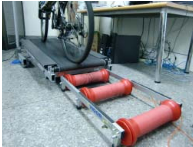
圖 3-7 平台式訓練車台。可防止騎乘者向後方掉落。
