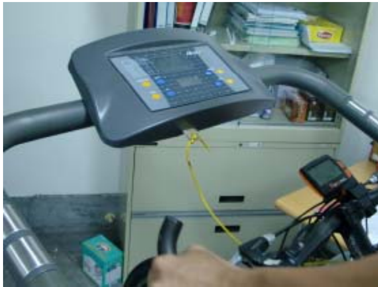
圖 3-5 跑步機安全插銷設備。當單車快滑出跑步機之前，會拉動此安全插銷，跑步機隨之斷電。
