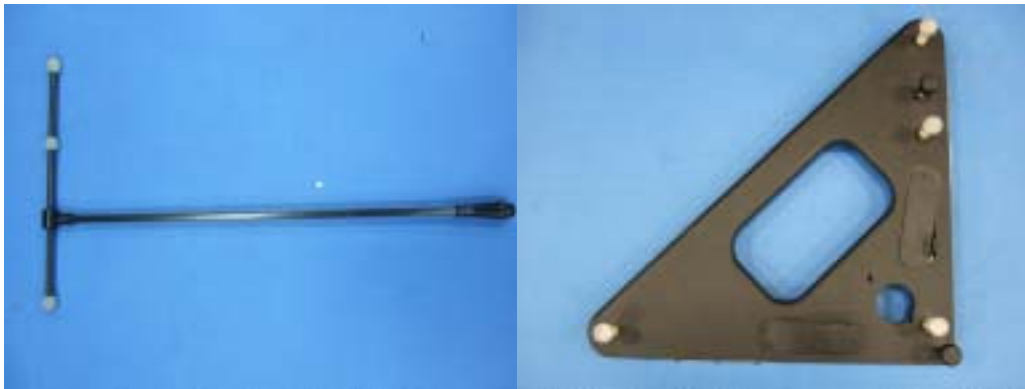
圖 3-3 T 型動態校正棒
