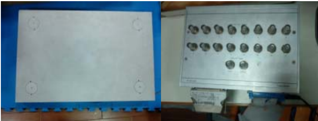
圖 1：地面反作用力測量的實驗儀器。(a) Kistler 9287BA 測力板；(b) Kistler 訊號集線盒。
