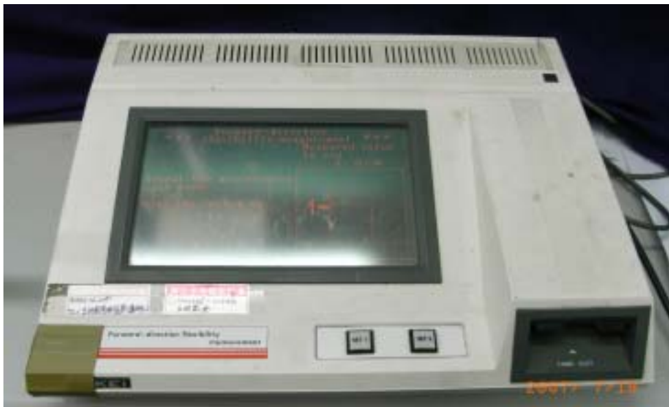
圖 1：線性移動儀系統。a.為線性移動儀；b.為電子顯示器。
