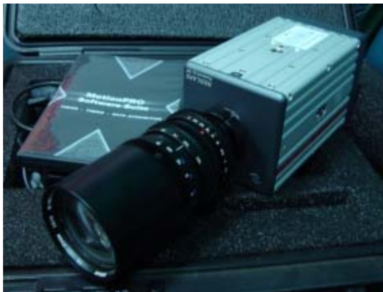
圖 3-2 高速攝影機 (MotionPro X3)
