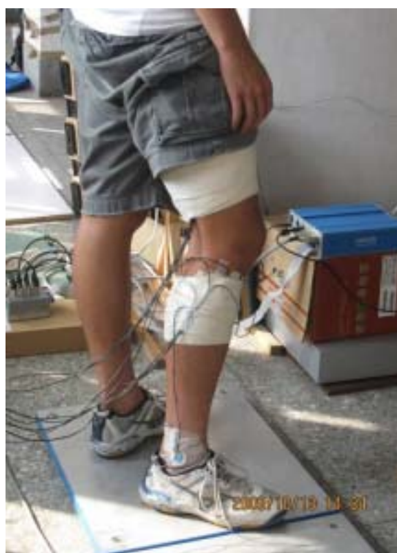
圖 3-6.2 受試者完成電極片之黏貼並站立於測力板
