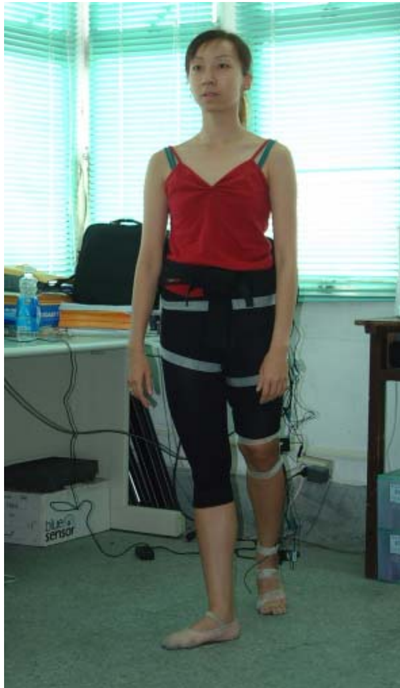
圖 3-7 各關節角度計及 Switch 足底平衡測量計在實驗參加者的配置圖
