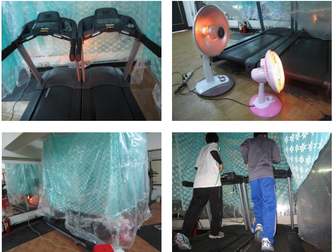
圖 3-10 跑步機與加熱器以及環境示意圖
