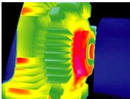
▲ 左圖為實圖；右圖為藉由紅外線強度，感受物體表面所散放出的溫度狀況
