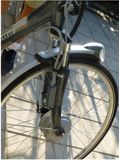
先進的 E-Bike 的動力馬達裝置
