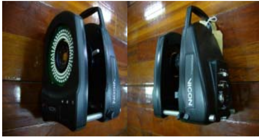
圖 3-4 VICON MX-F40 動作分析系統之紅外線攝影機
