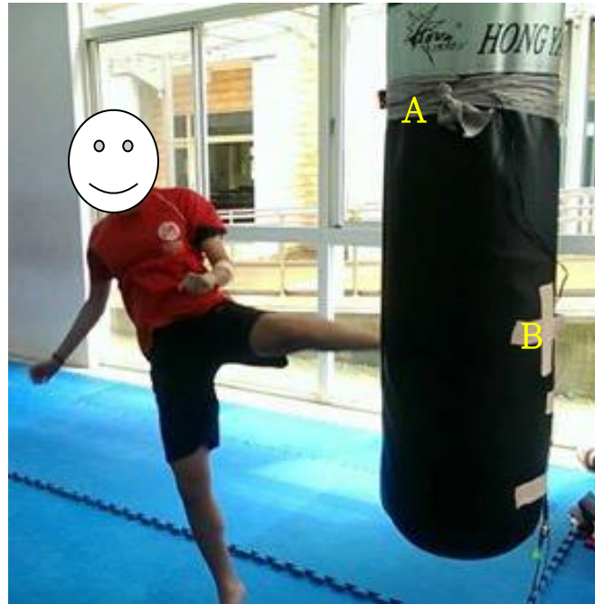
圖 5. 實驗儀器設置。(A 為刺激燈源，B 為加速度規)
