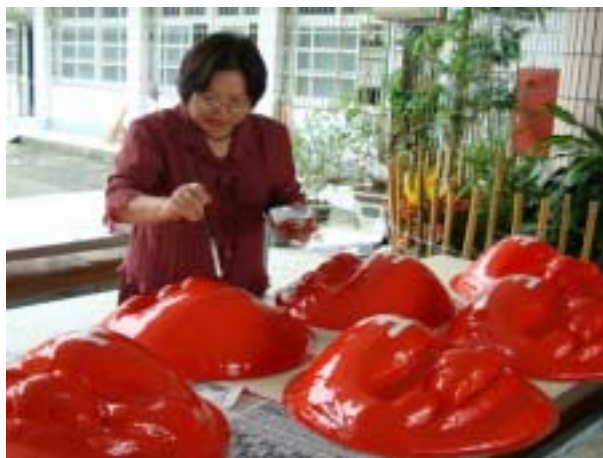
圖 3-7：張早校長在 PVC 壓模的初坯獅頭彩繪王字。
