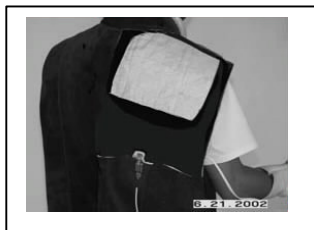
圖 1 有效刺擊的金屬感應片示例
